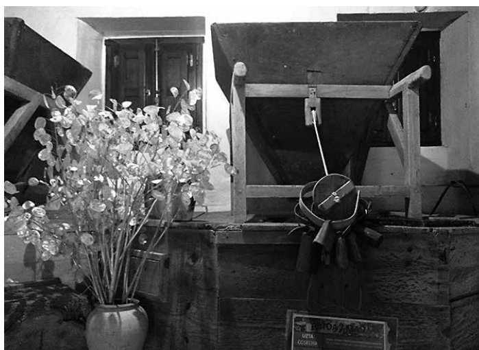
Errotak bi harri ditu, 'solera' behean eta 'voladora' gainean. MUNIA
