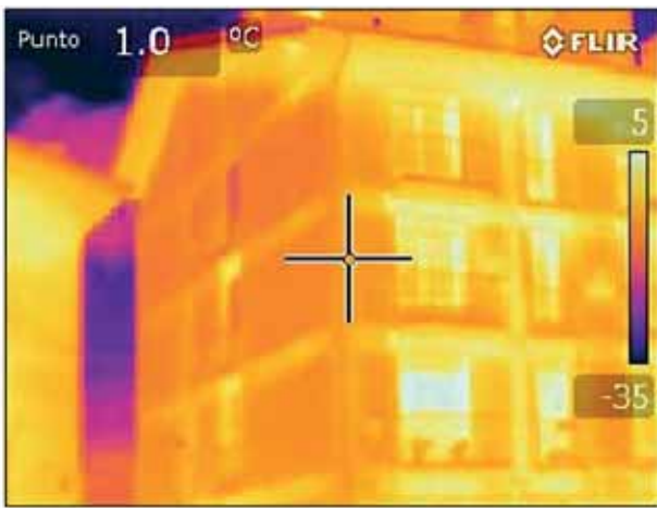
Obra egin aurretik etxebizitzetako berotasuna kanpora ateratzen zela erakusten du argazki termografikoak.
