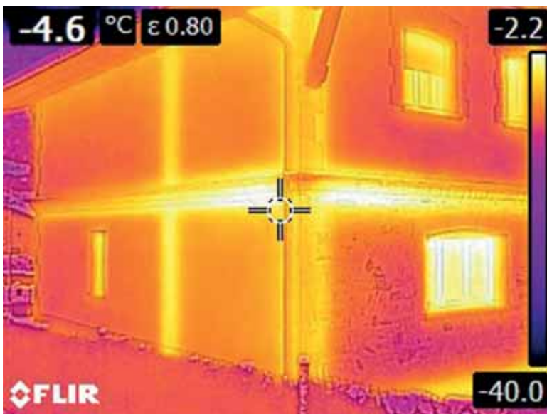
Argazki termografiko honetan argi eta garbi azaltzen da etxeko berotasunak nondik egiten duen ihes.
